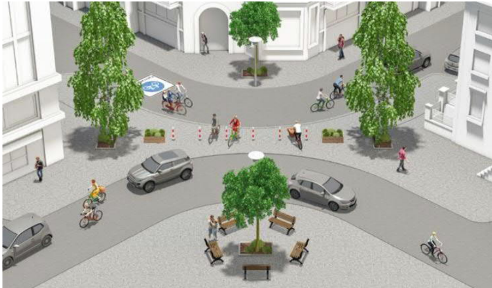
Abb. 99, Prinzipskizze einer Diagonalsperre (Quelle ADFC, „So geht Verkehrswende“, 2019)
